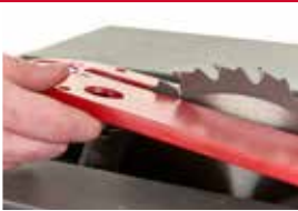
Zapadki zapobiegające odbiciu zatrzymują materiał chroniąc użytkownika
